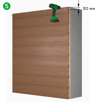
**NB!** В месте примыкания досок к стене дома или другому объекту следует оставлять зазор не менее 5 мм.
